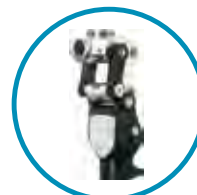
Rodilla policéntrica hidráulica 7 ejes, bloqueo geométrico y preflexión (Össur OTAL KNEE® 2000)
