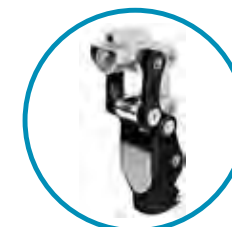
Rodilla policéntrica hidráulica 7 ejes, bloqueo geométrico (Össur TOTAL KNEE® 1900)
